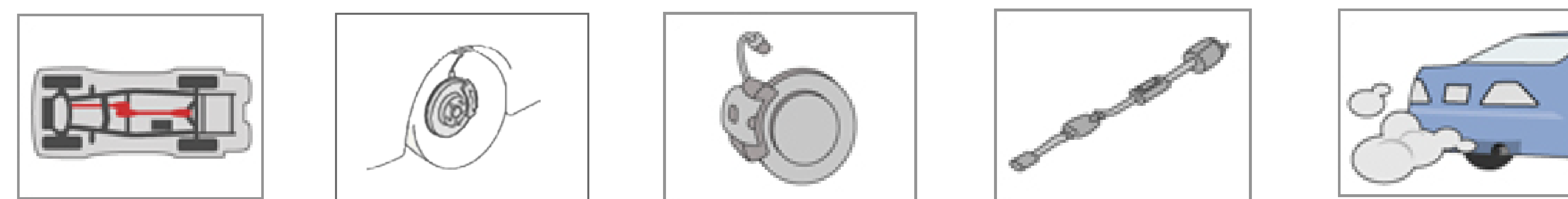
プロペラシャフトドライブシャフトの連結部のゆるみ ブレーキホースパイプの液漏れ 損傷、取付状態 ホイールシリンダディスクキャリパの液漏れ エキゾーストパイプマフラー・遮熱版のゆるみ・損傷 マフラーの機能
