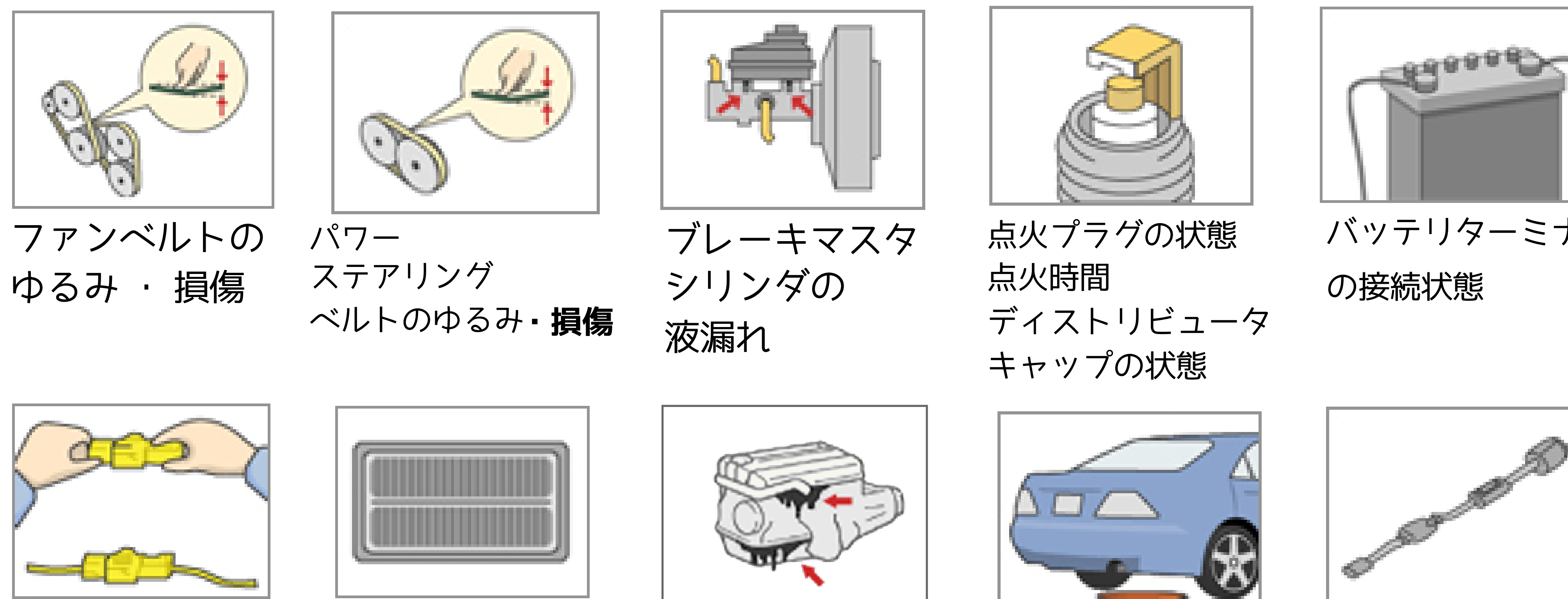
ファンベルトのゆるみ・損傷 パワーステアリングベルトのゆるみ・損傷 ブレーキマスターシリンダの液漏れ 点火プラグの状態 点火時間 ディストリビューターキャップの状態 バッテリーターミナルの接続状態 電気配線の接続部のゆるみ・損傷 エアクリーナーエレメントの状態 トランスミッショントランスファの油量・油漏れ 燃料もれ ばい煙および悪臭のあるガス 有害なガスなどの発散防止装置機能 損傷などの点検（10項目）
