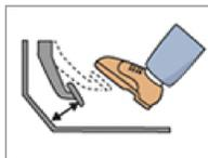
ブレーキペダルの遊びと床板の隙間
