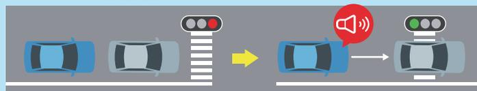
信号待ちなどでの停止時、前方車両が発進したことをブザーでお知らせします。
